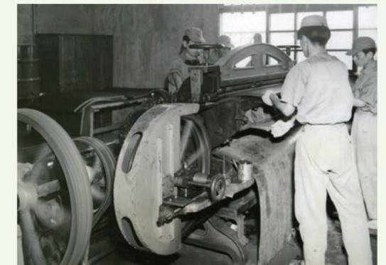
「積水スポンジ」設立当初の製品、塩ビスポンジの裁断作業風景(1960年頃撮影)
